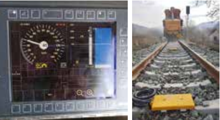
La implantación del sistema de señalización ERTMS Nivel 1 en toda la línea va a permitir aumentar la velocidad máxima de 70 a 120 km/h.
