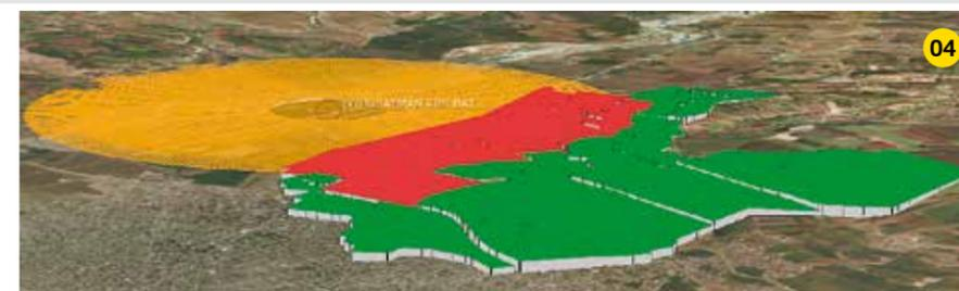
**Figura 5. RESULTADOS DE ANÁLISIS CVOR.** Ejemplo de resultados obtenidos en la simulación mediante la herramienta OUNPPM de una maniobra de aproximación apoyada en el sistema CVOR BAT. Resultados fuera de tolerancias en el caso de la urbanización propuesta originalmente (a la izquierda) y resultados admisibles en el caso del escenario propuesto por Ineco (a la derecha).
