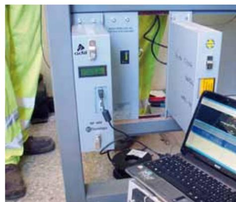
DESCARGA DE REGISTROS. El sistema permite descargar los datos del registrador 'in situ' (en la imagen) o a distancia, desde un puesto terminal.
