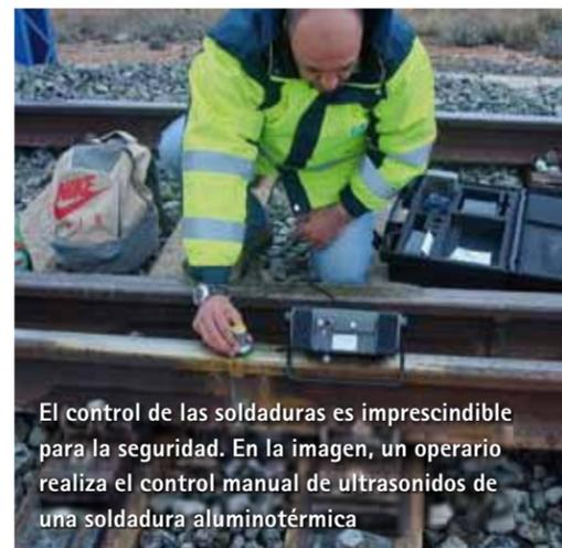
El control de las soldaduras es imprescindible para la seguridad. En la imagen, un operario realiza el control manual de ultrasonidos de una soldadura aluminotérmica
