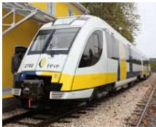
personas de movilidad reducida). La seguridad se ha extremado en todos los componentes. Disponen de sistema de Anuncio de Señales y Frenado Automático (ASFA digital), y la tecnología más moderna en ayudas a la conducción, sistemas de evacuación de emergencia y circuito cerrado de televisión para videovigilancia. ■
