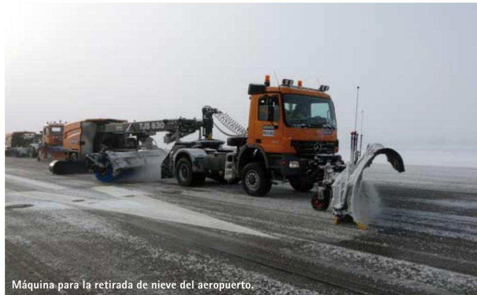
Máquina para la retirada de nieve del aeropuerto.
