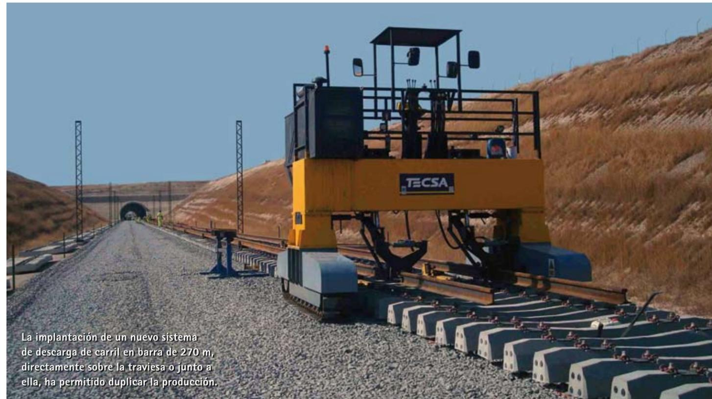
La implantación de un nuevo sistema de descarga de carril en barra de 270 m, directamente sobre la traviesa o junto a ella, ha permitido duplicar la producción.
