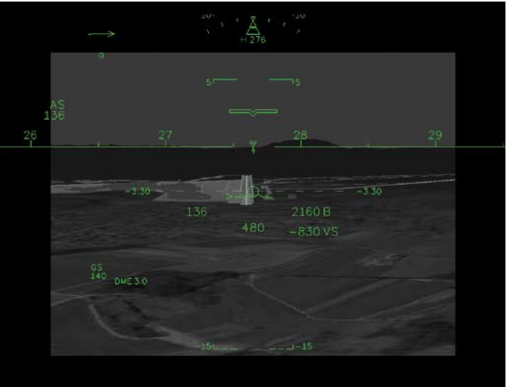
APROXIMACIÓN MEDIANTE EVS. Detalle de la simbología utilizada en el 'head-down display' durante una aproximación realizada en condiciones de baja visibilidad.
