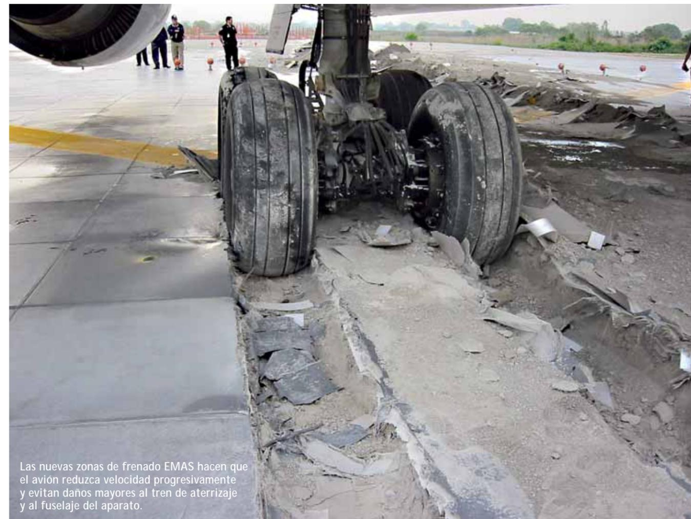
Las nuevas zonas de frenado EMAS hacen que el avión reduzca velocidad progresivamente y evitan daños mayores al tren de aterrizaje y al fuselaje del aparato.
