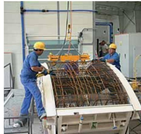
**DOVELAS A PIE DE OBRA.** El desarrollo en los sostenimientos ha sido grande: hormigones proyectados sin necesidad de encofrados y con resistencias adecuadas, anclajes de todo tipo que permiten un rápido sostenimiento de la roca, arcos metálicos (cerchas) y, finalmente, dovelas prefabricadas que permiten la aplicación de procesos muy industrializados cuando se utilizan máquinas TBM.
