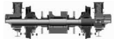
3. Simultáneamente se acciona el patín del cerrojo, liberando las ruedas, que pueden ser desplazadas por medio de resbaladeras de guiado lateral hasta alcanzar el nuevo ancho.
