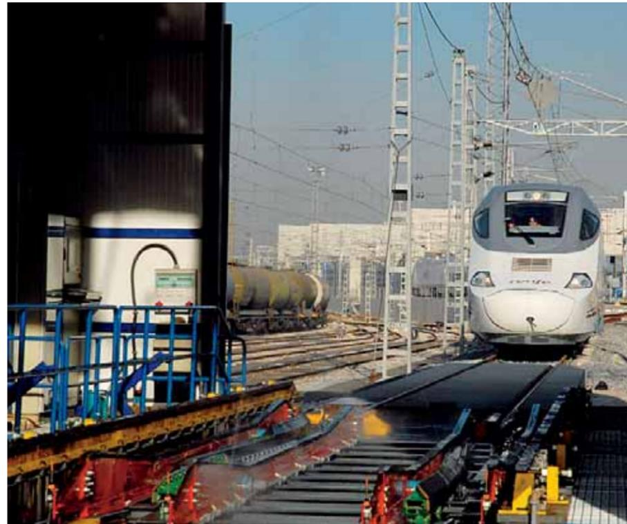
La operación de cambio de ancho de la rodadura del S130 se realiza fundamentalmente en cinco fases (que aparecen representadas esquemáticamente en la figura que aparece a la derecha). Estas operaciones son independientes de que el vehículo se encuentre en vacío o con la carga máxima admisible. Por su parte, el cambio de ancho variable en los S120 (que también se muestra esquemáticamente en la figura de la
