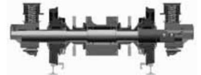
5. Al seguir ascendiendo, llega un momento en el que los rodillos dejan de apoyar sobre los carriles laterales, quedando el eje montado en condiciones de rodar por el nuevo ancho de vía.
