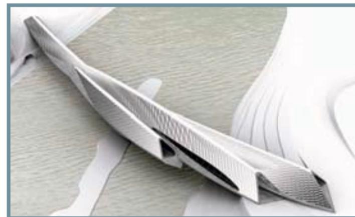
**GEOMETRÍA DEL PUENTE.** El diseño realizado por Zaha Hadid es una estructura orgánica sin una superficie definida matemáticamente. Su función: ser tanto un paseo peatonal como una sala para exposiciones.
