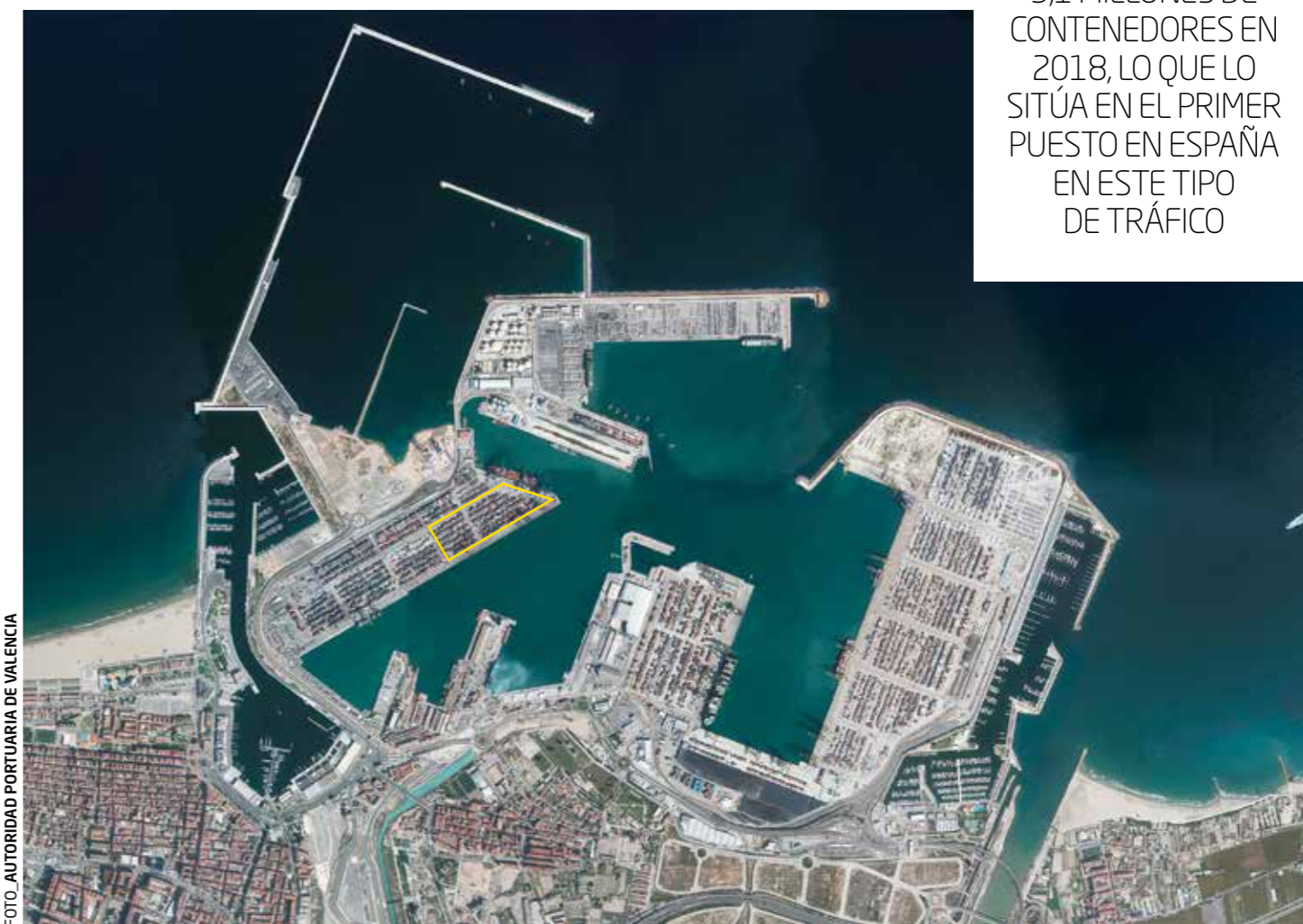
Muelle de Levante (enmarcado), donde se han llevado a cabo las actuaciones para el aumento de calado, refuerzo del muelle y ejecución de nueva viga cantil.
