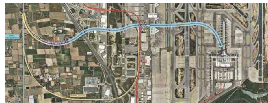
Trazado del nuevo acceso ferroviario de Cercanías al aeropuerto de El Prat. En azul, el tramo en túnel.
