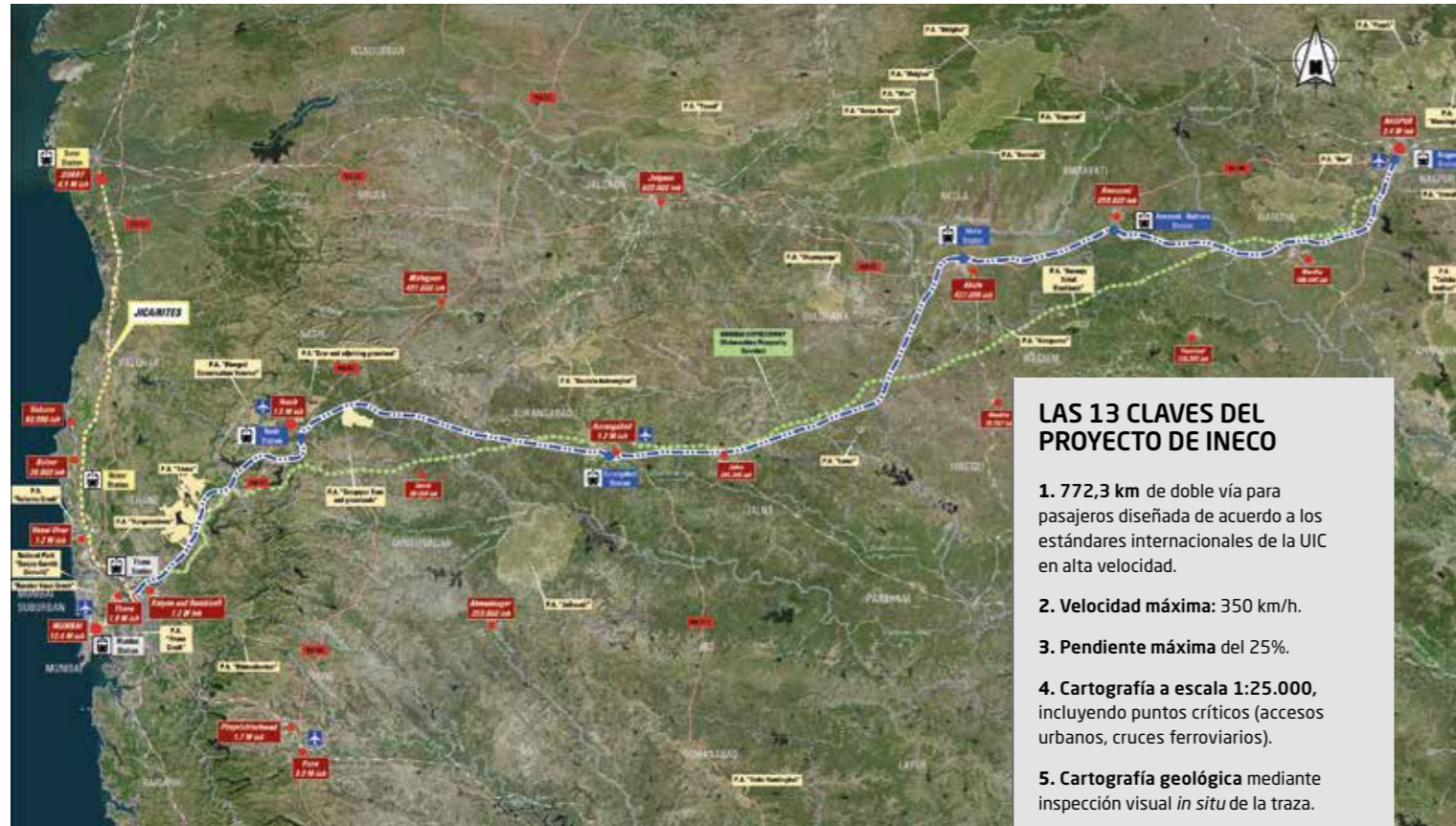
Esquema del estudio de viabilidad del corredor de alta velocidad Bombay-Calcuta, primera fase Bombay-Nagpur. En azul, la nueva línea de alta velocidad junto con las 5 estaciones del tramo, en verde, la autopista en estudio por parte de autoridades indias.
