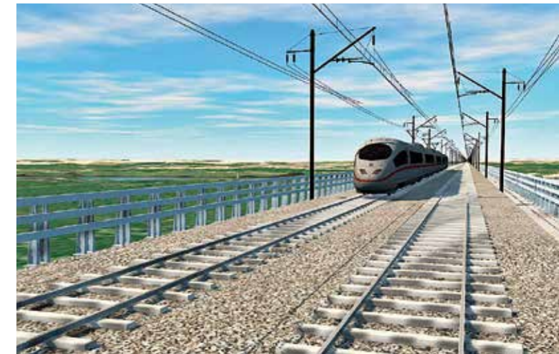
Infografía de la sección transversal: tramo de vía doble sobre balasto.
