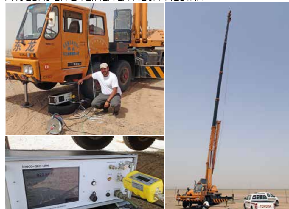
En la imagen superior izquierda, el ingeniero de Ineco, Alberto Trujillo, con un medidor de potencia; abajo a la izquierda, el transmisor de radio diseñado por el equipo de SPRING. A la derecha, antena situada sobre una grúa.
