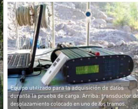
Equipo utilizado para la adquisición de datos durante la prueba de carga. Arriba: transductor de desplazamiento colocado en uno de los tramos.
