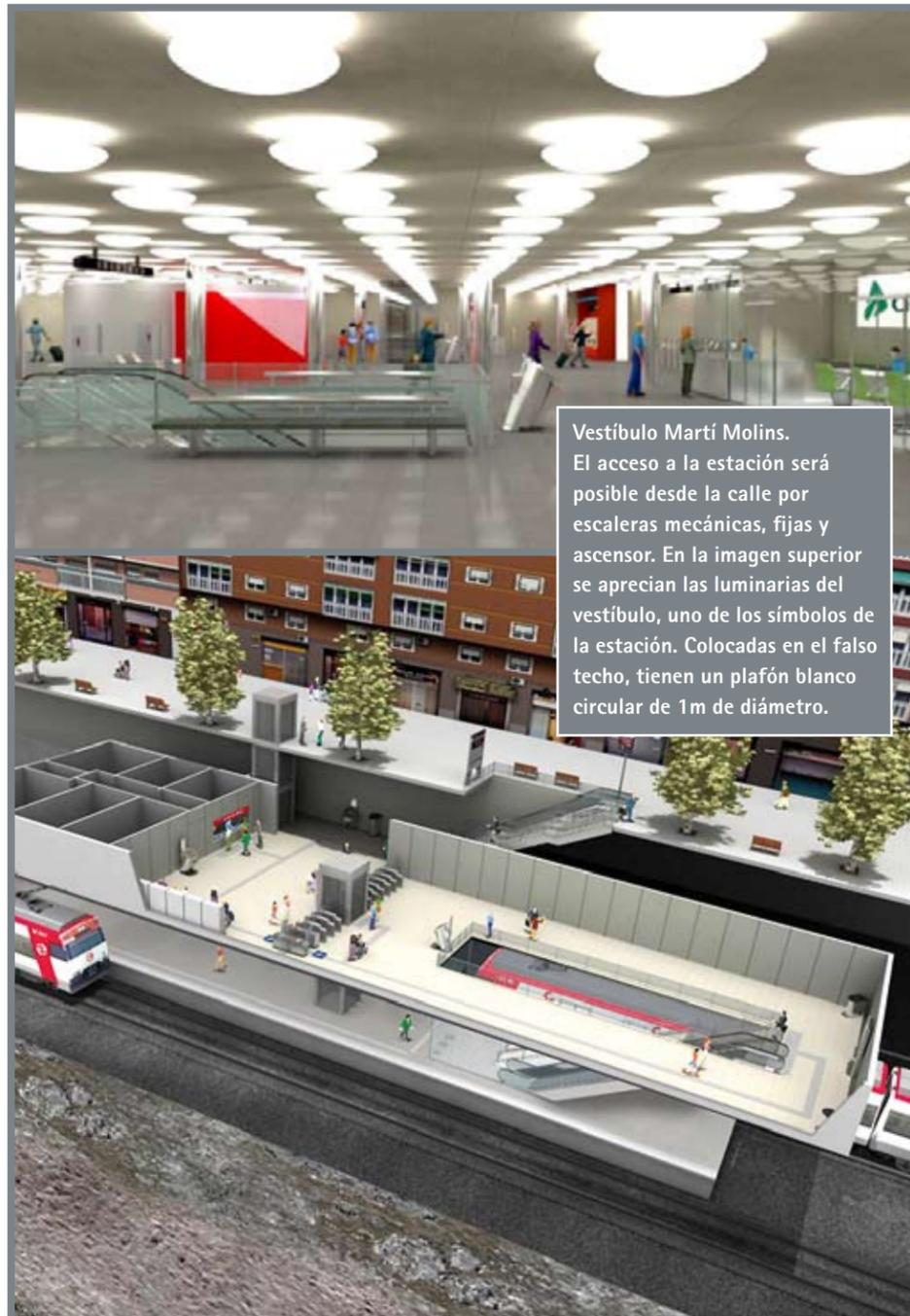
Vestíbulo Martí Molins. El acceso a la estación será posible desde la calle por escaleras mecánicas, fijas y ascensor. En la imagen superior se aprecian las luminarias del vestíbulo, uno de los símbolos de la estación. Colocadas en el falso techo, tienen un plafón blanco circular de 1 m de diámetro.
