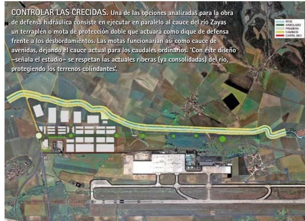
**CONTROLAR LAS CRECIDAS.** Una de las opciones analizadas para la obra de defensa hidráulica consiste en ejecutar en paralelo al cauce del río Zayas un terraplén o mota de protección doble que actuará como dique de defensa frente a los desbordamientos. Las motas funcionarían así como cauce de avenidas, dejando el cauce actual para los caudales ordinarios. 'Con este diseño –señala el estudio– se respetan las actuales riberas (ya consolidadas) del río, protegiendo los terrenos colindantes'.
